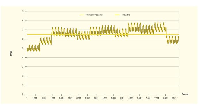
Abbildung 42: Stündliche H<sub>2</sub>-Nachfrageprofile für unterschiedliche Märkte.
