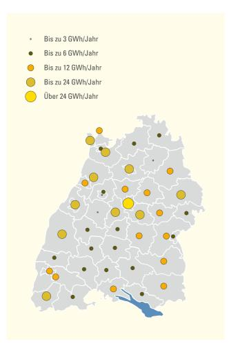
Abbildung 15: Verteilung des Wasserstoffabsatzpotenzials via Erdgasnetz im Jahr 2025.
