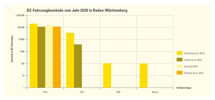
Abbildung 4: Ausblick auf Fahrzeugbestände wasserstoffbetriebener Straßenfahrzeuge bezogen auf Baden-Württemberg für das Eckjahr 2030. Anmerkungen: logarithmische Skalierung; LNF, SNF und Busse wurden nicht durch (Bonhoff 2012) und (Brokate et al. 2013) betrachtet. Im Rahmen von (Schott et al. 2012) wurden keine SNF und keine Busse betrachtet.
