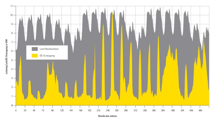
Abbildung 20: Szenario (Basisfall) der stündlichen Stromlast und Erzeugung aus erneuerbaren Energien in Baden-Württemberg beispielhaft für die ersten drei Wochen des Jahres 2030.
