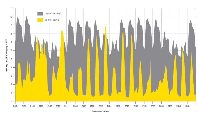
Abbildung 21: Szenario (Basisfall) der stündlichen Stromlast und Erzeugung aus erneuerbaren Energien in Baden-Württemberg beispielhaft für drei Wochen im April des Jahres 2030.
