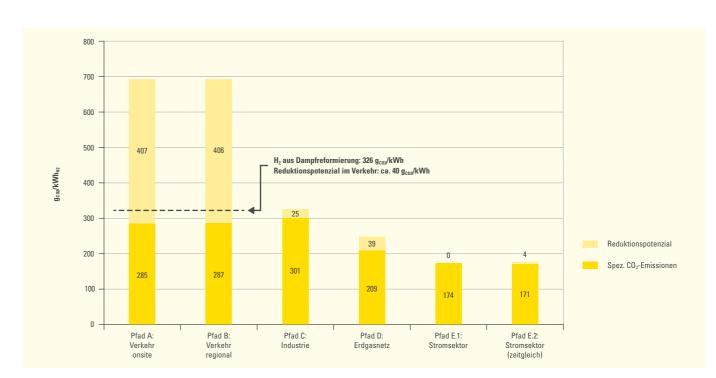
Abbildung 48: Spezifische CO<sub>2</sub>-Emissionen in den einzelnen Sektoren auf Basis des Strommix in Baden-Württemberg im Jahr 2030.
