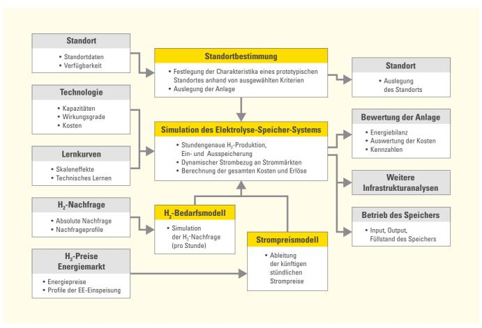
Abbildung 41: Übersicht über die Vorgehensweise im Rahmen der ökonomischen Bewertung der Geschäftsmodelle für ein prototypisches Elektrolyse-H<sub>2</sub>-Speicher-System.
