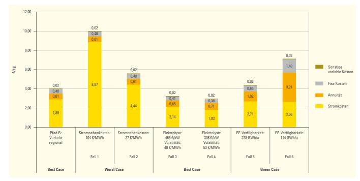
Abbildung 49: Spezifische H<sub>2</sub>-Kosten im Rahmen der Szenarioanalyse.
