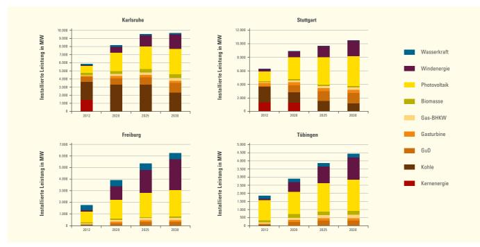
Abbildung 19: Szenario (Basisfall) der installierten Kraftwerksleistungen in den vier Regierungsbezirken Baden-Württembergs bis zum Jahr 2030.
