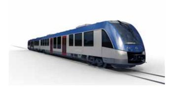
Abbildung 7: Designbild des Coradia LINT 54, Basis für den zukünftigen brennstoffzellenbetriebenen Hybridtriebzug (Copyright: Alstom).
