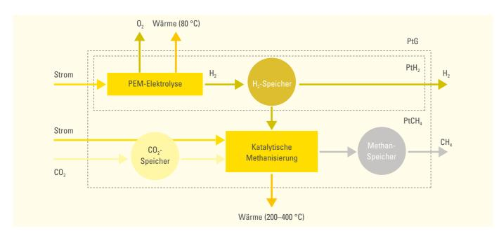
Abbildung 14: Vereinfachtes Anlagenschema einer PtH2-Anlage mit PEM-Elektrolyse und einer PtCH4-Anlage mit katalytischer Methanisierung (eigene Darstellung).
