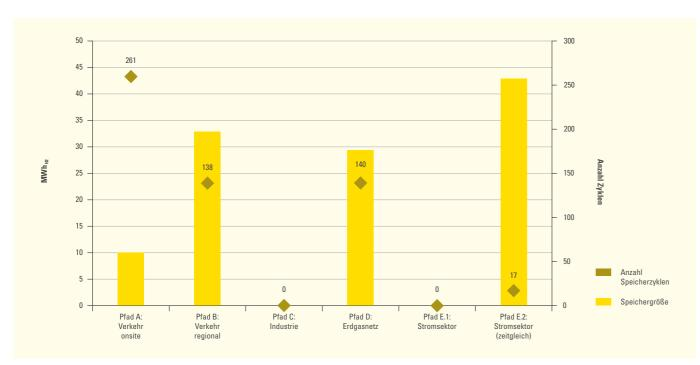
Abbildung 45: Größe und jährliche Zyklenzahl der H<sub>2</sub>-Speicher in einzelnen Sektoren.
